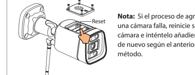
**Nota:** Si el proceso de agregar una cámara falla, reinicie su cámara e inténtelo añadiendo de nuevo según el anterior método.
