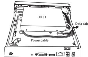
3. Coloque el HDD en la parte inferior del dispositivo y luego apriete los tornillos en la parte inferior para el HDD.
